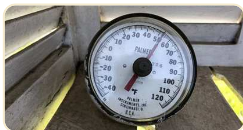
دماسنج میله‌ای برای آب پاستوریزاسیون
